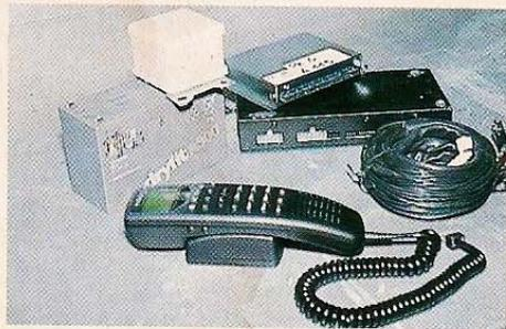
*In alto, le componenti del sistema. Il cubo bianco è il sensore di sollevamento; a sinistra, una fase del montaggio.*
